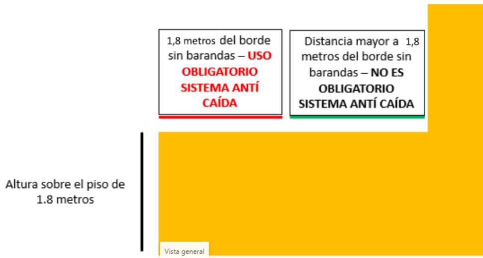
*Ilustración 1- Esquema de Uso de Sistema Anti Caída en Plataformas Fijas*
