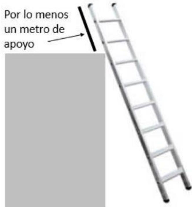
Ilustración 2 - Apoyo de Escalera en Parte Superior
